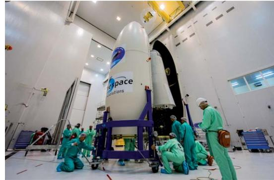
Sopra: le fasi di inserimento di IXV nella carenatura del vettore Vega. Sotto: il lancio e il velivolo in mare.
