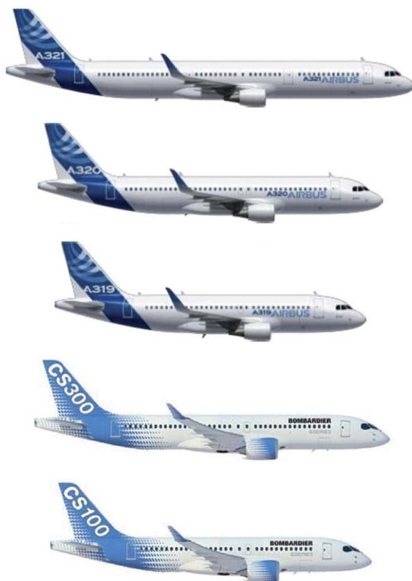
Con l'acquisizione del programma CSeries dalla Bombardier, Airbus offre una completa gamma di velivoli a corridoio singolo che copre il segmento dai 100 posti del CS100 fino ai 240 dell'A321.
